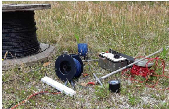
Figure 1: Esempi strumentazione per indagini indirette
